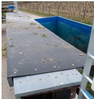
**BAVETTE TIROIR EN CAOUTCHOU RENFORCÉ** posée sur la banque, souple et amovible pour ne pas être endommagée lors des phases de manutention de benne.
